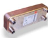
**Recupero totale di calore:** consiste in uno scambiatore a piastre saldobrasate in acciaio AISI 316. In base alla temperatura della sonda acqua di recupero, il gas caldo viene inviato nello scambiatore di recupero trasferendo all'acqua l'energia di condensazione.
