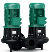
**Kit pompa gemellare:** n°1 pompa gemellare montata all'interno dell'unità, con una pompa impiegate come backup. Il kit è completo di valvola di ritegno sulla mandata della pompa gemellare, interruttore automatico di protezione e teleruttore di comando per ciascuna pompa. La gestione delle pompe viene affidata direttamente al microprocessore con commutazione a tempo (per equilibrare le ore di funzionamento).
