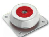
**Supporto antivibrante a campana:** riducono la trasmissione delle vibrazioni prodotte dalla macchina. Elemento elastico in gomma naturale resistente a temperature di esercizio da -20 a +90°C. Corpo metallico con superficie zincata UNI ISO 2081 Fe/Zn 15c1A bianca e acciaio UNI EN 10111 DD13..
