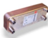
**Recupero totale di calore:** consiste in uno scambiatore a piastre saldobrasate in acciaio AISI 316. In base alla temperatura della sonda acqua di recupero, il gas caldo viene inviato nello scambiatore di recupero trasferendo all'acqua l'energia di condensazione. **Total heat recovery:** brazed-plate type heat exchanger in steel AISI 316. Based on the recovery water probe temperature, the warm gas is sent to the total heat recovery heat exchanger by giving to the water the condensation energy.
