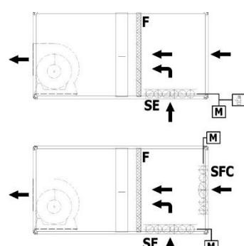
**CAMERA DI MISCELA 3 SERRANDE** Gestione completa dei flussi aria di mandata, ripresa ed immissione di aria esterna, con espulsione automatica dell'aria di ripresa, con l'adozione di un ventilatore di ripresa VR. **MIX CHAMBER 3 DAMPERS** Complete management of supply air flows, intake and introduction of external air, with automatic expulsion of the return air, by means of VR intake fan.
