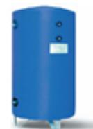
**Vaso di espansione:** assorbe le variazioni di volume subite dal liquido per effetto della variazione della temperatura di esercizio. In acciaio verniciato a polveri epossidiche di lunga durata con membrana fissa in gomma SBR. **Expansion vessel:** absorbs liquid volume variations caused by working temperature variations. In epoxy powder coated steel, long-lasting duration with steady membrane made in SBR rubber.
