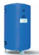
**Kit modulo accumulo:** fornisce all'acqua la prevalenza necessaria a percorrere il circuito idraulico e giungere ai terminali. Serbatoio: in acciaio al carbonio di alta qualità, isolato con poliuretano rigido iniettato con bassa conducibilità termica per ridurre al minimo le dispersioni. L'accumulo è contenuto in una carpenteria aggiuntiva e posizionato sulla base dell'unità.
