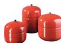
**Vaso di espansione:** assorbe le variazioni di volume subite dal liquido per effetto della variazione della temperatura di esercizio. In acciaio verniciato a polveri epossidiche di lunga durata con membrana fissa in gomma SBR. **Expansion vessel:** absorbs liquid volume variations caused by working temperature variations. In epoxy powder coated steel, long-lasting duration with steady membrane made in SBR rubber.
