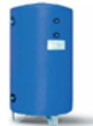
**Vaso di espansione:** assorbe le variazioni di volume subite dal liquido per effetto della variazione della temperatura di esercizio. In acciaio verniciato a polveri epossidiche di lunga durata con membrana fissa in gomma SBR. **Expansion vessel:** absorbs liquid volume variations caused by working temperature variations. In epoxy powder coated steel, long-lasting duration with steady membrane made in SBR rubber.
