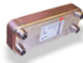
**Recupero totale di calore:** consiste in uno scambiatore a piastre saldobrasate in acciaio AISI 316 fino alla taglia 330.2, a fascio tubiero dalla taglia 380.3. In base alla temperatura della sonda acqua di recupero, il gas caldo viene inviato nel recuperatore trasferendo all'acqua l'energia di condensazione.
