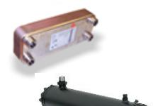
**Recupero totale di calore:** consiste in uno scambiatore a piastre saldobrastrate in acciaio AISI 316 fino alla taglia 270.2, a fascio tubiero dalla taglia 300.3. In base alla temperatura della sonda acqua di recupero, il gas caldo viene inviato nel recuperatore trasferendo all'acqua l'energia di condensazione.
