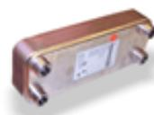
**Recupero totale di calore:** consiste in uno scambiatore a piastre saldabrasate in acciaio AISI 316 fino alla taglia 330.2, a fascio tubiero dalla taglia 380.3. In base alla temperatura della sonda acqua di recupero, il gas caldo viene inviato nel recuperatore trasferendo all'acqua l'energia di condensazione.
