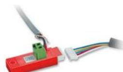
**Sistema di controllo e assistenza remota:** permette l'assistenza e il controllo remoto dell'unità da PC mediante accesso da browser web. Connessione al web server remoto mediante la rete aziendale. In caso di allarme è possibile l'invio di alert via SMS o e-mail. Disponibile in 4 versioni:
