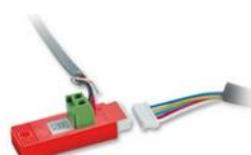
**Sistema di controllo e assistenza remota:** permette l'assistenza e il controllo remoto dell'unità da PC mediante accesso da browser web. Connessione al web server remoto mediante la rete aziendale. In caso di allarme è possibile l'invio di alert via SMS o e-mail. Disponibile in 4 versioni:
