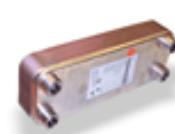
**Recupero totale di calore:** consiste in uno scambiatore a piastre saldobrastrate in acciaio AISI 316 fino alla taglia 310.2, a fascio tubiero dalla taglia 360.3. In base alla temperatura della sonda acqua di recupero, il gas caldo viene inviato nel recuperatore trasferendo all'acqua l'energia di condensazione.
