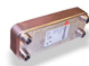
**Kit-Desurriscaldate:** consiste in uno scambiatore a piastre saldobrastrate in acciaio AISI 316. In base alla temperatura della sonda acqua di recupero, il gas caldo viene inviato nel desurriscaldate recuperando fino al 25% del calore di condensazione. La condensazione viene poi completata sul condensatore standard con un aumento delle prestazioni del sistema. Bene si abbina con il controllo velocità ventilatori o ventilatori EC per un miglior sfruttamento dell'accessorio.
