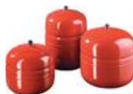
**Vaso di espansione:** assorbe le variazioni di volume subite dal liquido per effetto della variazione della temperatura di esercizio. In acciaio verniciato a polveri epossidiche di lunga durata con membrana fissa in gomma SBR. **FORNITO SMONTATO Expansion vessel:** absorbs liquid volume variations caused by working temperature variations. In epoxy powder coated steel, long-lasting duration with steady membrane made in SBR rubber. TO ASSEMBLE
