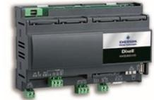
**Microprocessore CAREL:** microprocessore evoluto di progettazione Carel gestisce automaticamente la regolazione della temperatura dell'acqua, tempistiche e rotazione dei compressori, gli allarmi, visualizza sul display lo stato di funzionamento dell'unità, la temperatura di mandata e di ritorno dell'acqua dall'impianto e il codice degli allarmi.
