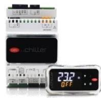
**Microprocessore CAREL:** microprocessore evoluto di progettazione Carel gestisce automaticamente la regolazione della temperatura dell'acqua, tempistiche e rotazione dei compressori, gli allarmi, visualizza sul display lo stato di funzionamento dell'unità, la temperatura di mandata e di ritorno dell'acqua dall'impianto e il codice degli allarmi.
