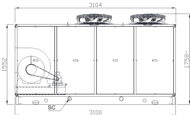
SC=SCARICO CONDENSA-DRAIN DISCHARGE
