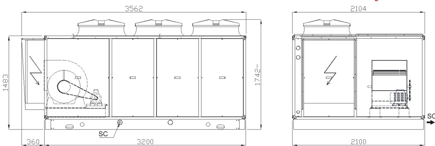
SC=SCARICO CONDENSA-DRAIN DISCHARGE
