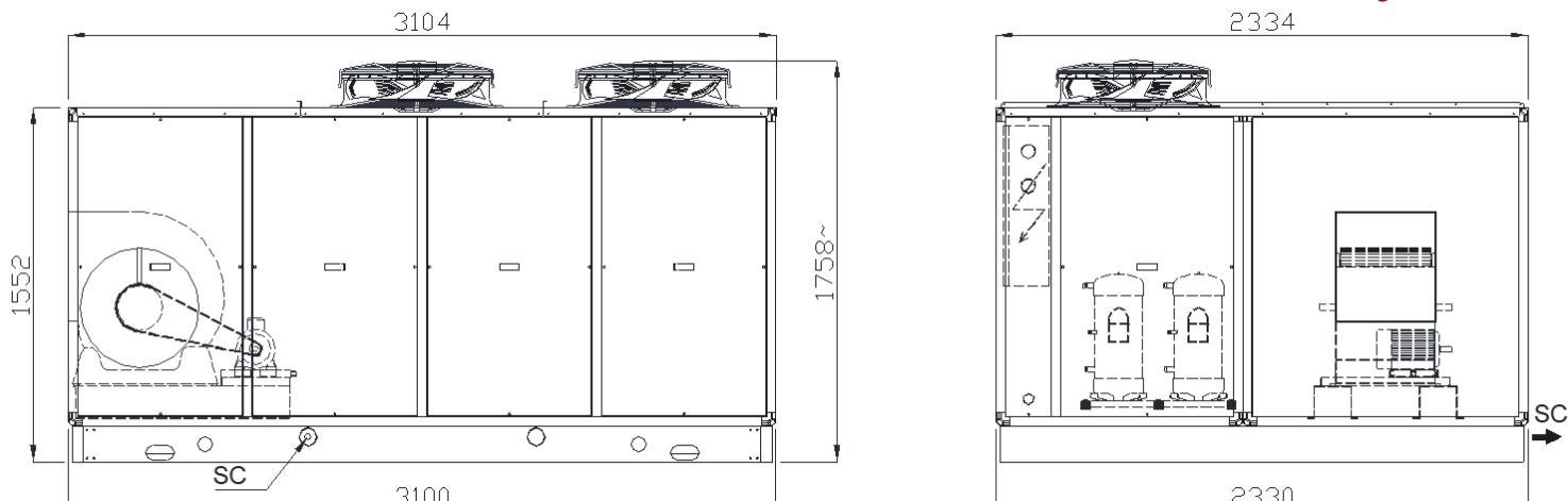
SC=SCARICO CONDENSA-DRAIN DISCHARGE
