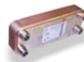
**Recupero totale di calore:** consiste in uno scambiatore a piastre saldobrasate in acciaio AISI 316. In base alla temperatura della sonda acqua di recupero, il gas caldo viene inviato nello scambiatore di recupero trasferendo all'acqua l'energia di condensazione. **Total heat recovery:** brazed-plate type heat exchanger in steel AISI 316. Based on the recovery water probe temperature, the warm gas is sent to the total heat recovery heat exchanger by giving to the water the condensation energy.
