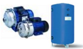
**Vaso di espansione:** assorbe le variazioni di volume subite dal liquido per effetto della variazione della temperatura di esercizio. In acciaio verniciato a polveri epossidiche di lunga durata con membrana fissa in gomma SBR. Sciolto
