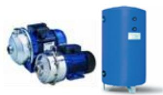
**Vaso di espansione:** assorbe le variazioni di volume subite dal liquido per effetto della variazione della temperatura di esercizio. In acciaio verniciato a polveri epossidiche di lunga durata con membrana fissa in gomma SBR. **Expansion vessel:** absorbs liquid volume variations caused by working temperature variations. In epoxy powder coated steel, long-lasting duration with steady membrane made in SBR rubber.
