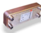
**Recupero totale di calore:** consiste in uno scambiatore a piastre saldobrasate in acciaio AISI 316. In base alla temperatura della sonda acqua di recupero, il gas caldo viene inviato nel recuperatore trasferendo all'acqua l'energia di condensazione.
